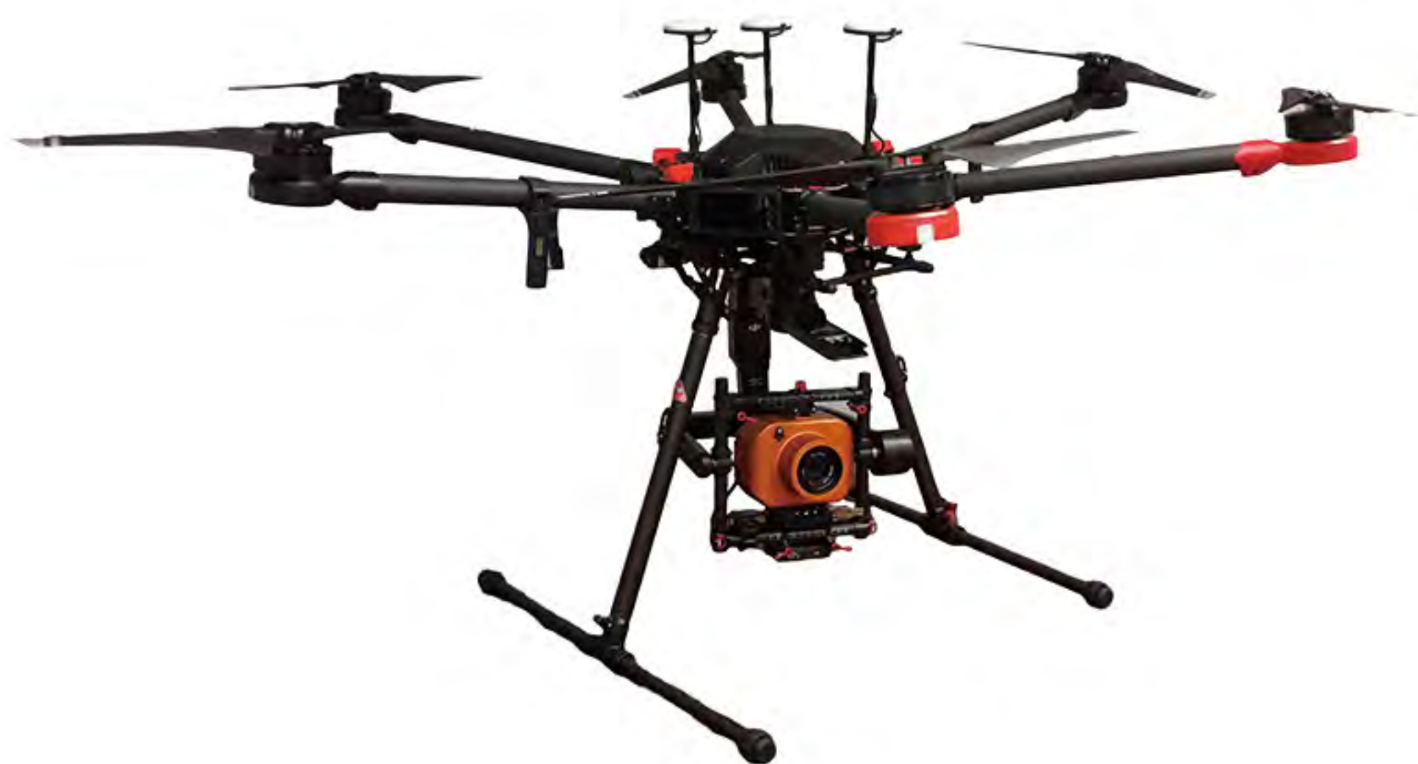
DJI M600 Pro及Ronin-MX云台, 可垂直或者倾斜拍摄, 适用于城市大比例尺, 斜坡测图, 应急测绘
