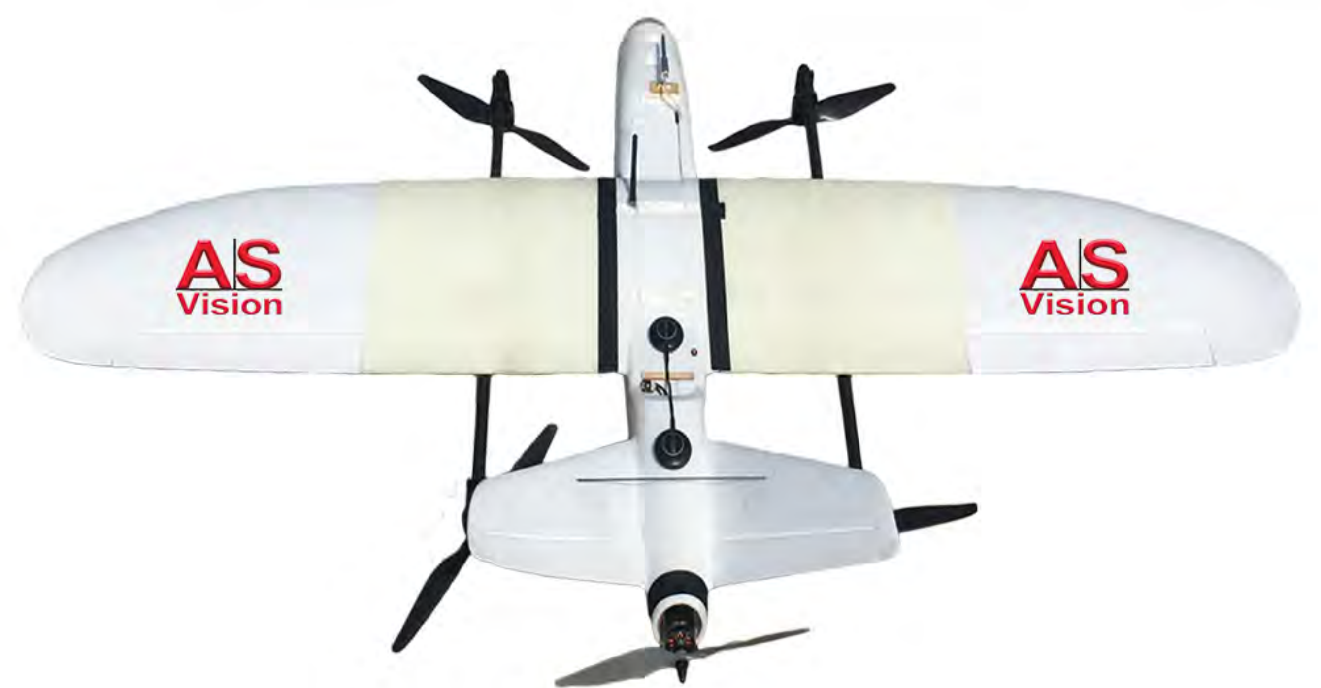
eAgle无人机采用强化泡沫制成, 总重量小于7KG (适用于国际城市航空飞行法规限制, 包括电池+相机)
